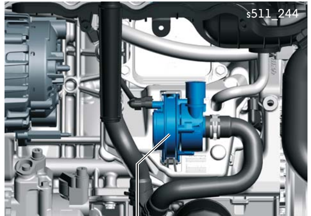
Pumpe für Ladeluftkühlung V188
